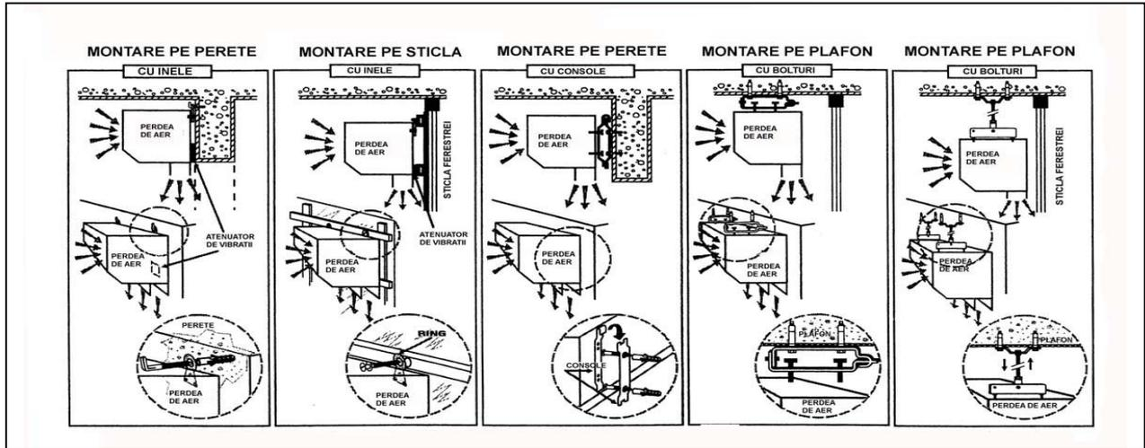
Va rugam sa retineti: Inelele (P/N: 33640018) sunt piese standard pentru tipurile R(L)-11, R(L)-12, R(L)-13 in timp ce toate celelalte furnizate cu console (P/N: 33640030 si 33640029) sunt de asemenea prevazute ca componente standard. Restul componentelor indicate in figurile de mai sus intra in responsabilitatea instalatorului.
